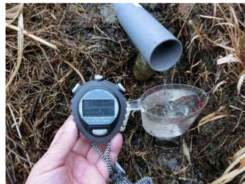
後法 漏水量測定(近景)
