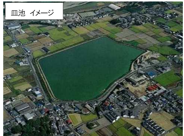
皿池 イメージ 平地で窪地の周囲に堤防を築いて造られたため池
