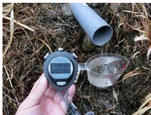
後法 漏水量測定(近景)
