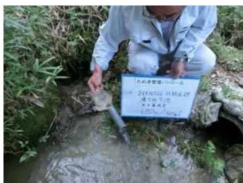
後法 漏水量測定(遠景)
