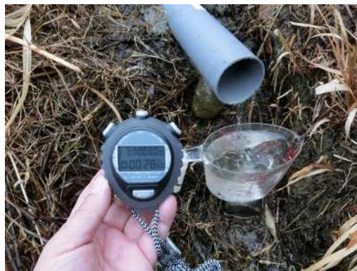
後法 漏水量測定(近景)
