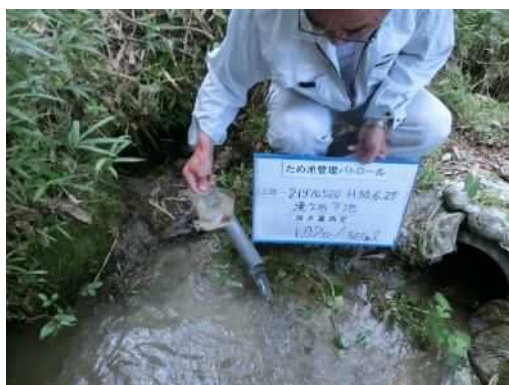
後法 漏水量測定(遠景)
