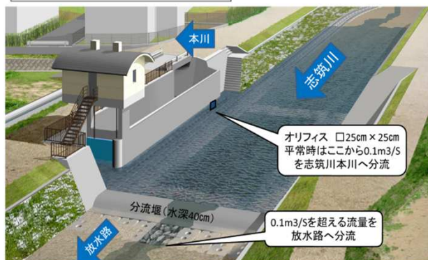
志筑川放水路 分流施設(洪水時)
