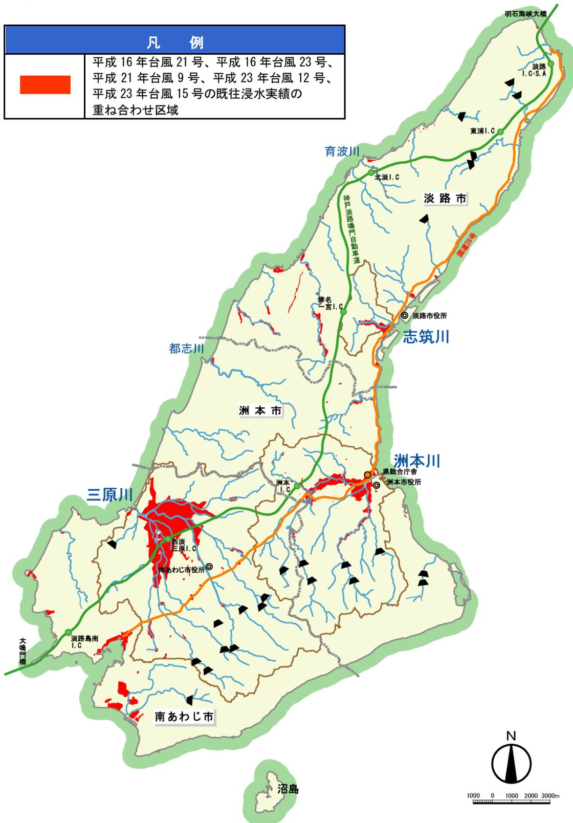
図 13 既往浸水実績の重ね合わせ図(平成 16 年、21 年、23 年)
