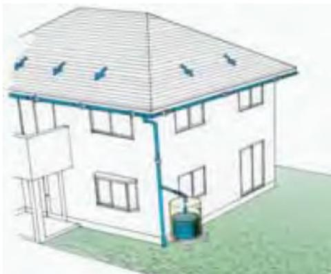
図15 各戸貯留施設の例(地上タイプ)
