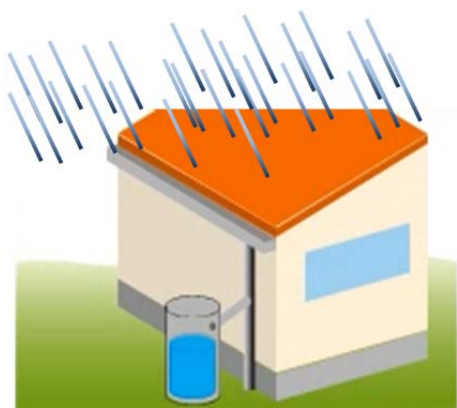
屋根に降った雨水を貯留
