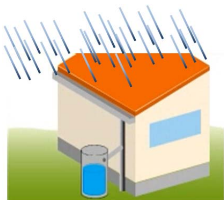
屋根に降った雨水を貯留
