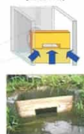
切欠きから排水
