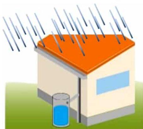
屋根に降った雨水を貯留
