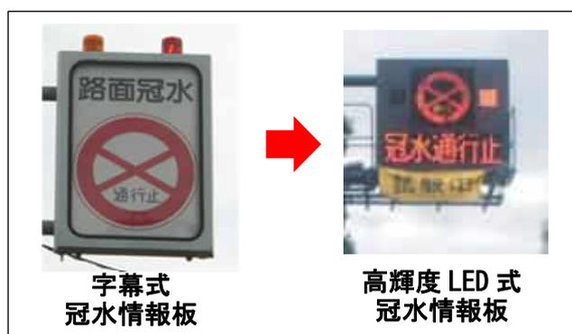
冠水情報板の高輝度 LED 式化
