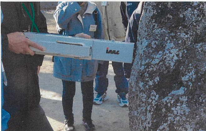
桜の樹幹内部腐朽空洞診断(レンジストグラフ)の実施研修(左)と、内部の腐敗で樹皮だけの切株(右)。
