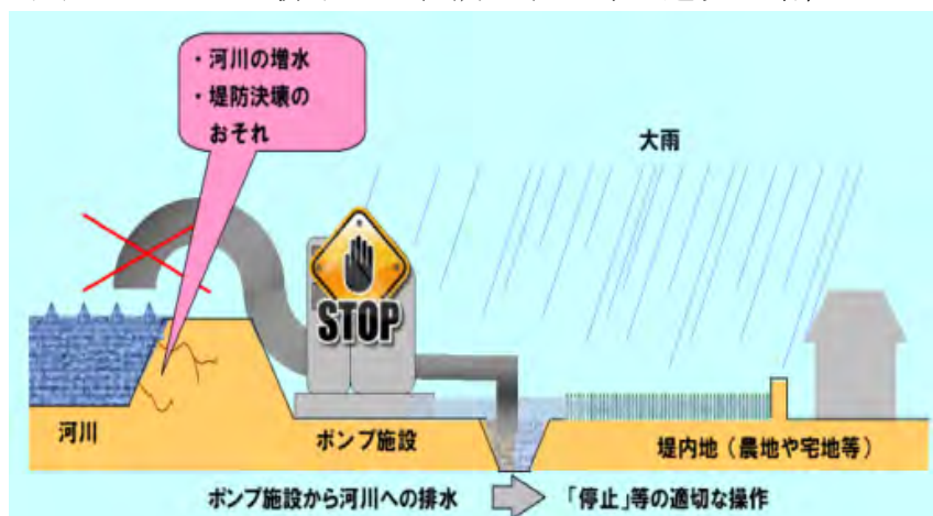
出水時における河川へのポンプ運転施設の運転調整
