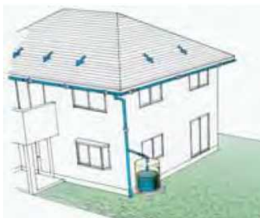
図 53 各戸貯留施設の例(地上タイプ)
