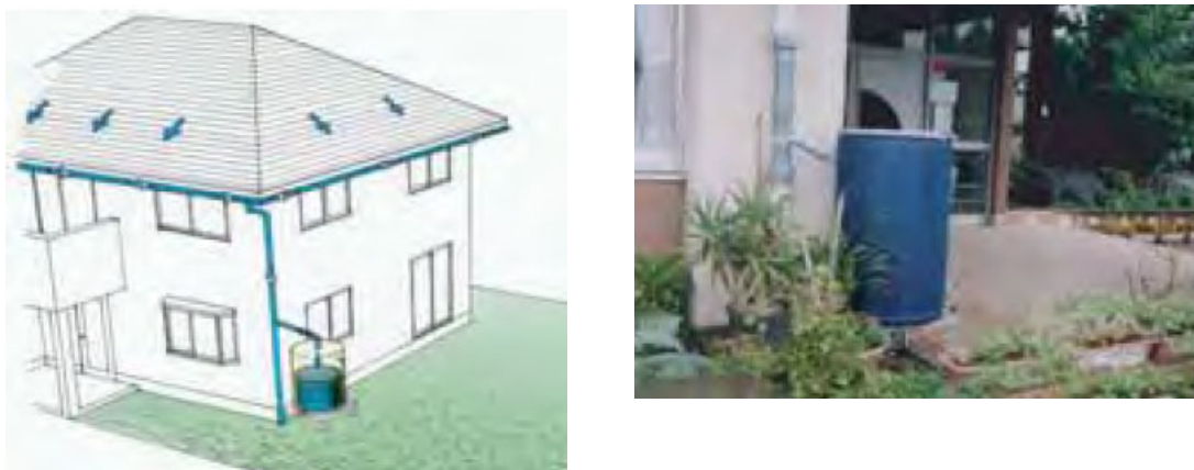
図 35 各戸貯留施設の例(地上タイプ)
