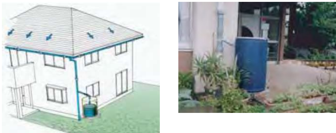
図 19 各戸貯留施設の例(地上タイプ)
