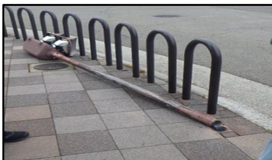
【腐食と人圧により倒壊した信号柱】
