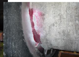
施設の劣化状況（左：雨水ポンプ用エンジンH6年製 オイル漏れ 右：遠心濃縮機H5年製 内部の亀裂）
