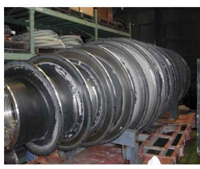
施設の劣化状況（左：雨水ポンプ用エンジンH6年製 オイル漏れ 右：遠心濃縮機H5年製 内部の亀裂）
