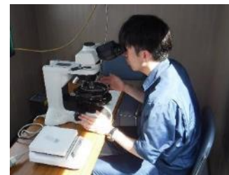
立入現場で速やかに検鏡し、アスベスト漏洩の有無を確認
