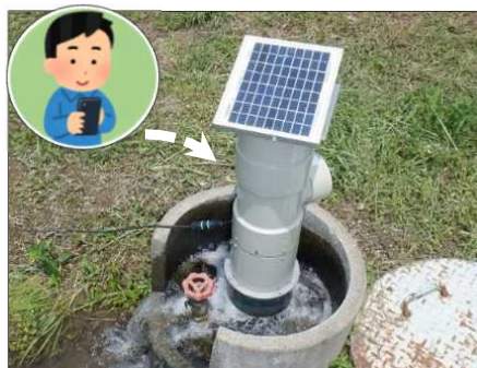
水管理労力を軽減する遠隔操作型自動給水栓 (たつの市金剛山(こんごうさん)地区)
