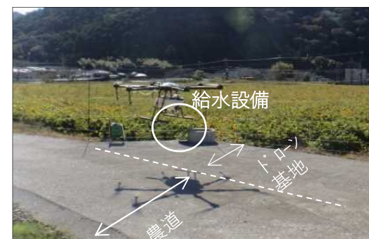
農薬散布時の給水設備を備えたドローン離発着基地 (姫路市宮置地区)
