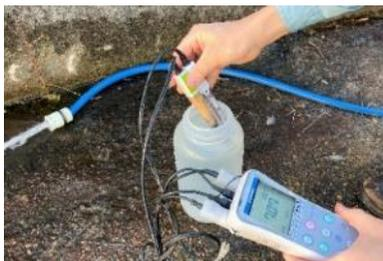
地下水の採水・測定
