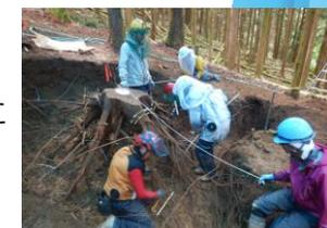
スギの根系強度を算出するための根系分布調査
