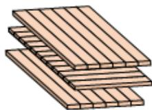
図2 幅方向に接合した板を直交するように積層接着(3層)
