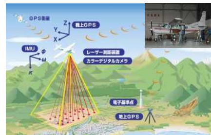
【効果1】測量作業の効率化(現地測量→航空レーザー測量)
