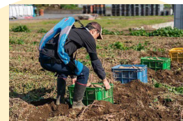
アシストスーツ 持ち上げ作業等の負荷を軽減、作業時間を短縮
