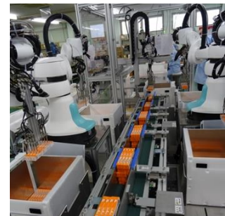
ロボット導入例 歯ブラシの箱詰め 作業自動化
