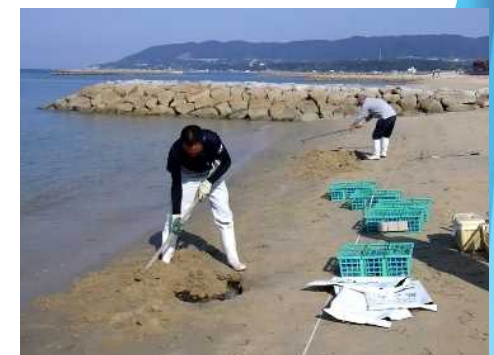
有機肥料による栄養添加試験 （波打ち際への埋設）（淡路市）
