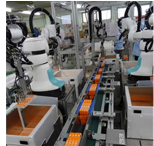
ロボットによる箱詰め作業
