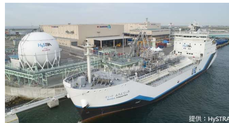
参考：神戸港で実証が進む液化水素の運搬船と貯蔵タンク
