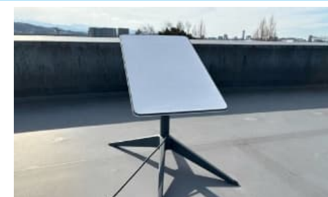
低軌道衛星通信（スターリンク） ※アンテナを置いて電源(非常用自家発電機等)をつなぐのみ
