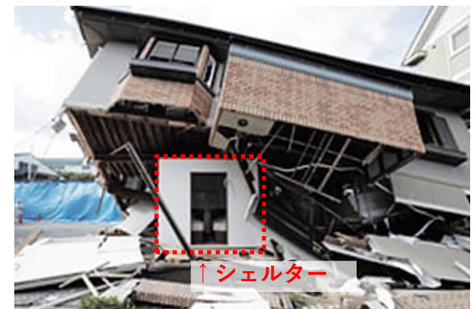
耐震シェルター一家屋倒壊実験
