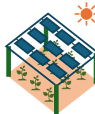
ペロブスカイト太陽電池を活用した営農型太陽光発電設備のイメージ
