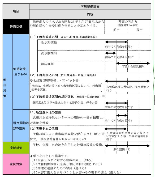
※1 計画高水位以上の洪水に対して堤防を決壊しにくくするための堤防強化については、計画高水位以下の洪水に対する 浸透・侵食対策が完了した後に、可能なものから実施する。
