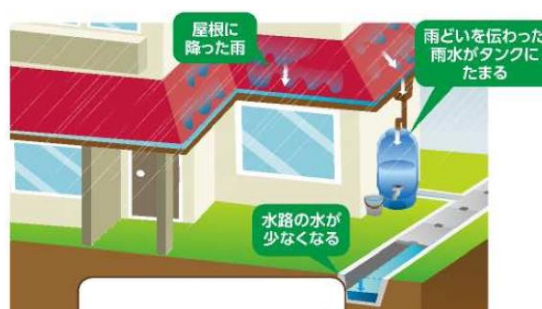
【雨水貯留タンク】
