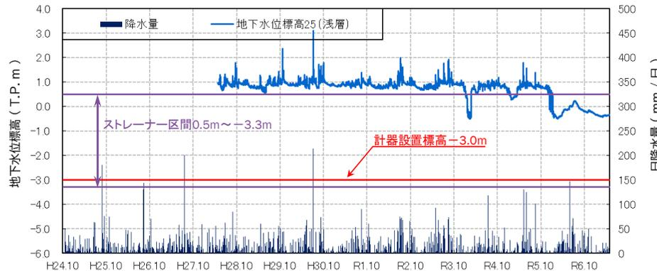
・地下水水位は、降雨の影響により敏感に変動する。水位は標高0.9m前後である。河川工事の影響により、令和3年12月～令和4年2月、令和4年12月～令和5年5月に一時的に水位低下が認められる。令和5年11月以降、河川工事の影響で水位低下が認められる。
