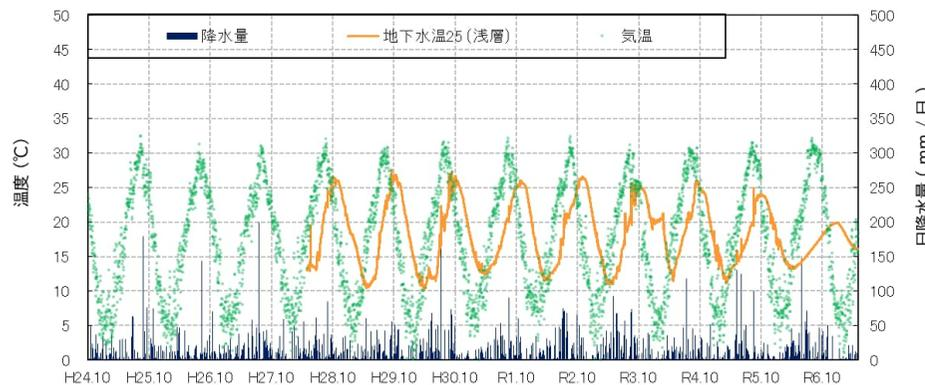
・水温は10℃～28℃で大きく変動し周期性をもっており気温と比較して概ね2か月ピークのずれであったが、令和6年3月以降から変動は13℃～20℃と小さくなり気温と比較して概ね4か月のピークのずれとなった。
