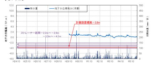
・地下水位は、降雨の影響により変動する。令和元年11月~令和2年5月、令和3年12月~令和4年3月は河川工事による影響で水位低下の傾向がみられた。
