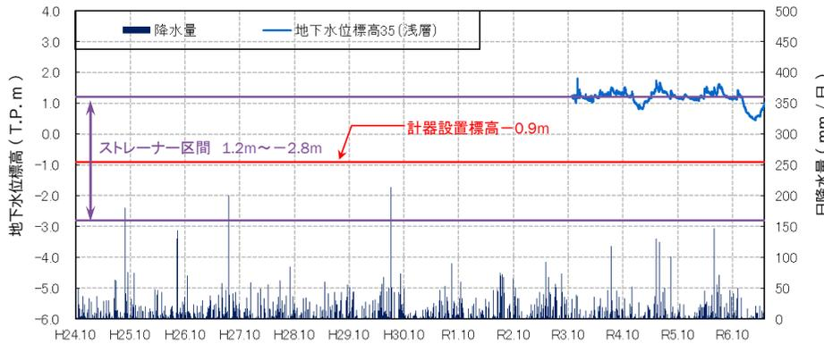
・地下水位は標高1.2m前後であるが、降雨の影響により変動する。令和4年11月以降に河川工事の影響で一時的に低下した。また令和6年11月下旬以降、河川工事の影響で低下傾向にあったが、河川工事終了後は回復傾向である。
