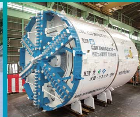
津門川地下貯留管シールドマシン
