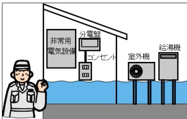
図 7-10 電気設備の浸水対策
