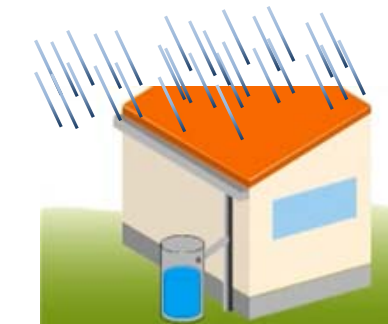
屋根に降った雨水を貯留
