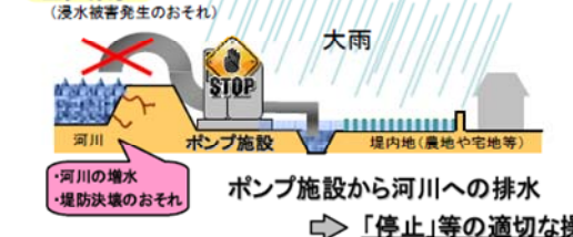
図 6-7 排水ポンプの運転調整
