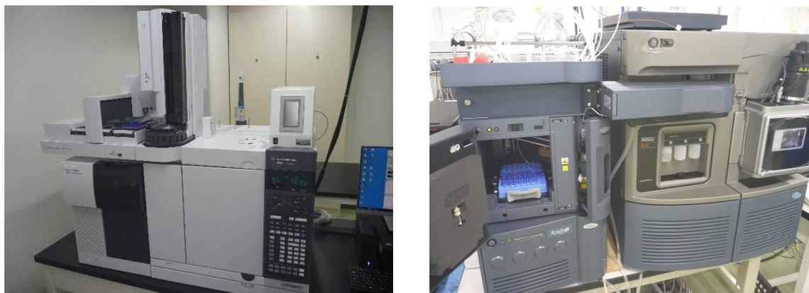
図 3 質量分析計（左；GC-MS/MS、右；LC-MS/MS）
