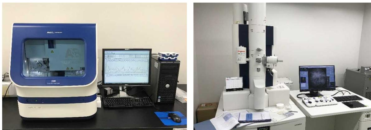
図 4 左 ; DNA シーケンサー、右 ; 透過型電子顕微鏡
