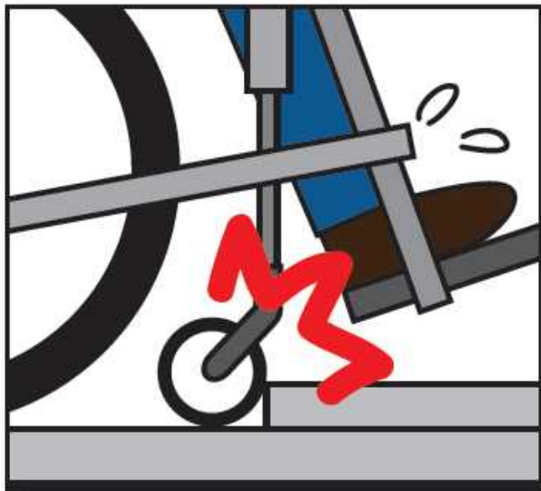
3cm程度の道路の段差
