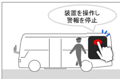
運転手等が車両後部の装置を操作すると警報が停止
