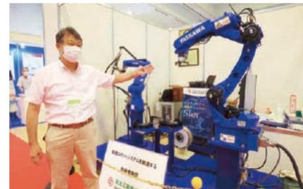
「このロボットは配管パイプの長さや太さに関係なく、同じ動作で自動的に溶接作業をします」と代表取締役の高丸正さん。
