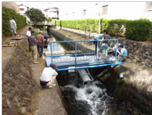
農業用水を活用した「小水力発電らせん式水車」(たつの市)
