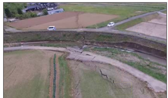
地表の断層のずれによる亀裂 (平成28年熊本地震)
