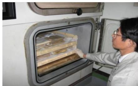
真空凍結乾燥機に資料を設置する様子
