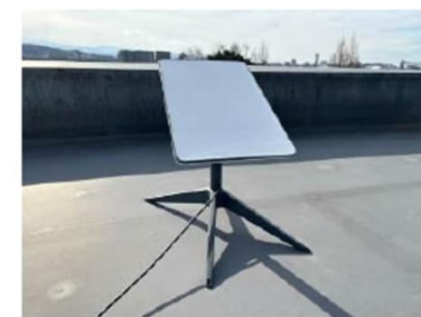
低軌道衛星通信（スターリンク） ※アンテナを置いて電源をつなぐのみ
