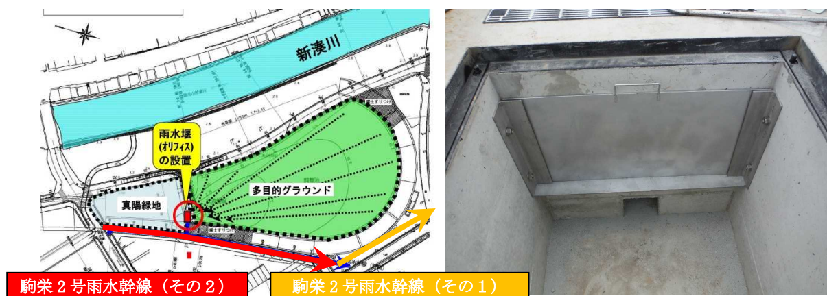
図 2.5.2 真陽南さくらグラウンドにおける流出調整機能施設(オリフィス)の整備
