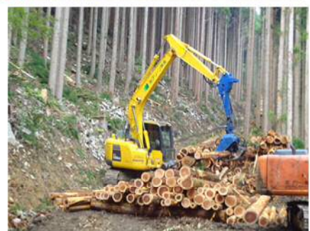
伐採木の玉切・集材状況(プロセッサ)
