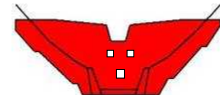
えん堤工 H=9.0m、L=50.0m
