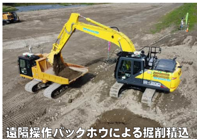
自動走行不整地運搬車による運搬
