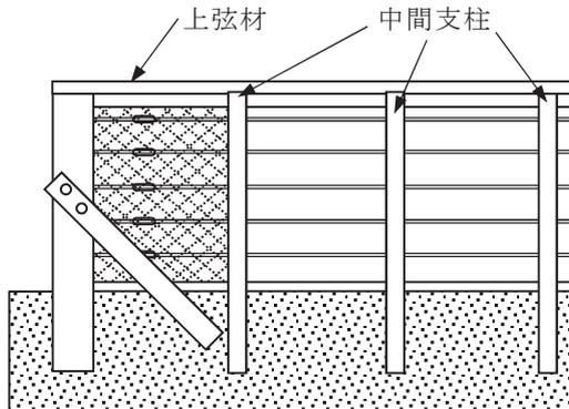
○落石防護柵 柵高の考え方
