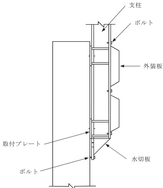
※水切り板の設置高さは、施工基面からとする。
