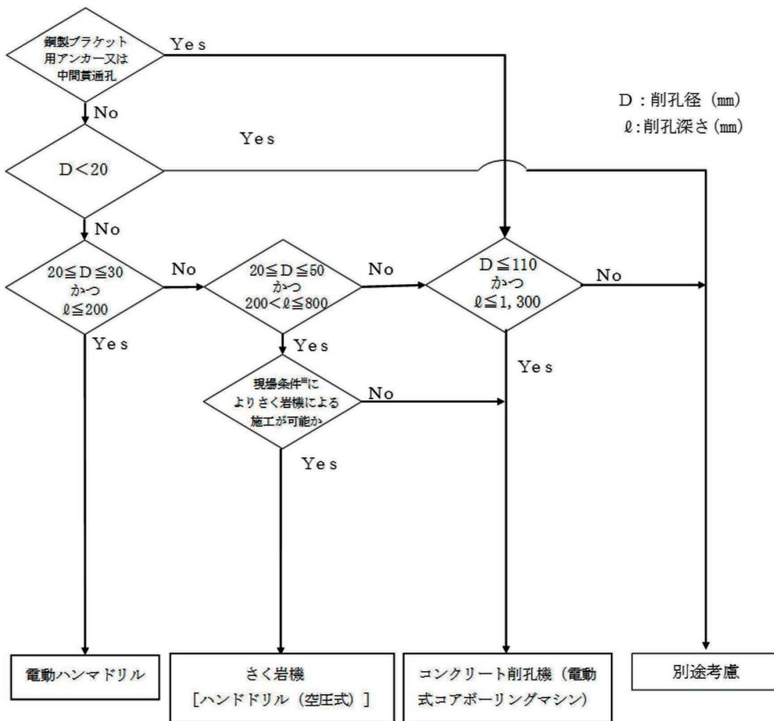
※現場条件とは、作業スペース、騒音・振動による制限及び既設配筋間隔等による施工障害とする。
