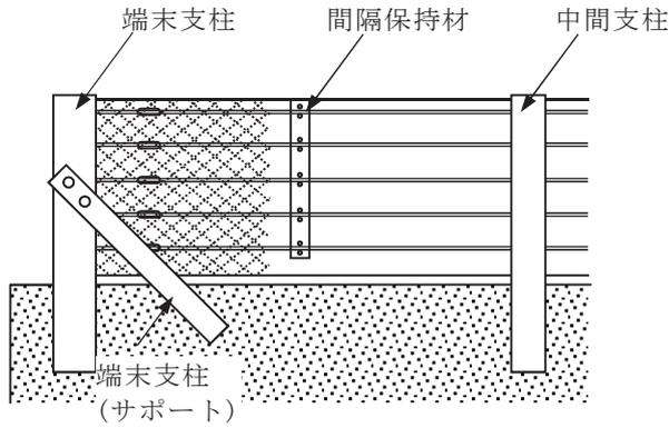
○耐雪型落石防護柵（上弦材付き）3.0m間隔
