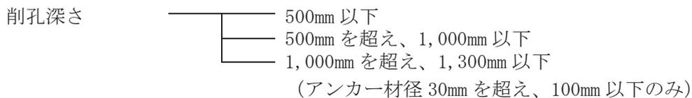
(4) コンクリート削孔 (さく岩機 [ハンドドリル] (空圧式)) の削孔深さによる区分は、以下のとおりとする。
