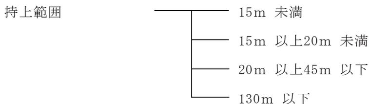
(5) 吊柵アンカーの吊柵アンカー規格による区分は、以下の通りとする。
