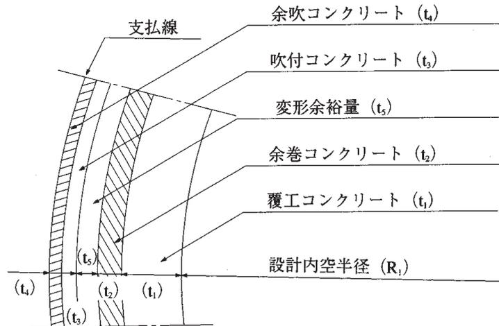
設計掘削半径 = 設計内空半径 ( $R_1$ ) + 覆工コンクリート厚 ( $t_1$ ) + 吹付コンクリート厚 ( $t_3$ ) + 変形余裕量 ( $t_5$ )
