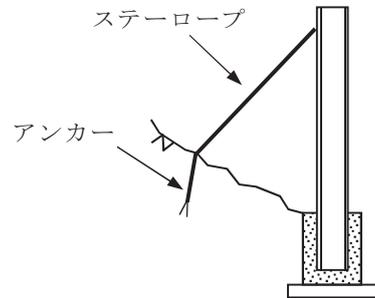
○耐雪型落石防護柵（上弦材付き）2.0m間隔
