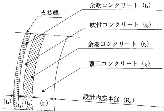
設計掘削半径 = 設計内空半径 (R<sub>1</sub>) + 覆工コンクリート厚 (t<sub>1</sub>) + 吹付コンクリート厚 (t<sub>3</sub>)
