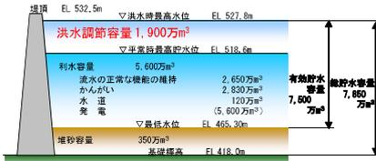
新たに1,900万m<sup>3</sup>の洪水調節容量を確保
